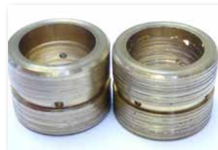
Die tiefen Riefen auf der Innen- und Außenseite des Radiallagers stammen eindeutig von harten Schmutzpartikeln wie Ölkohle und Lagerabrieb.
