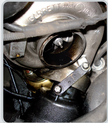
Bild Nr. 4: Öl im Lufttrichter
