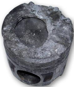
Bild Nr. 37: Geschmolzener Kolbenboden
