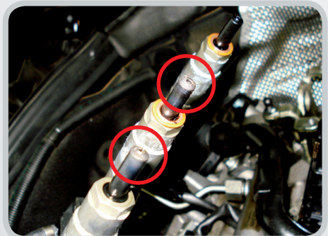
Bild Nr. 36: Defekte Einspritzdüsen
