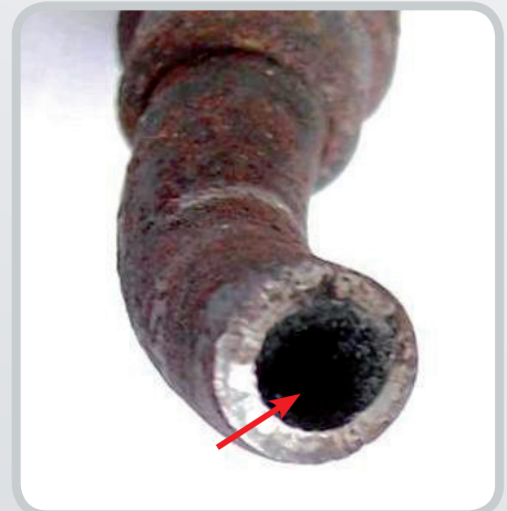
Bild Nr. 39: Verkockte Leitung mit thermischer Verfärbung
