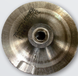
Bild Nr. 2: Strahlenförmiger Ölauftrag auf der Rückseite des Verdichterrades
