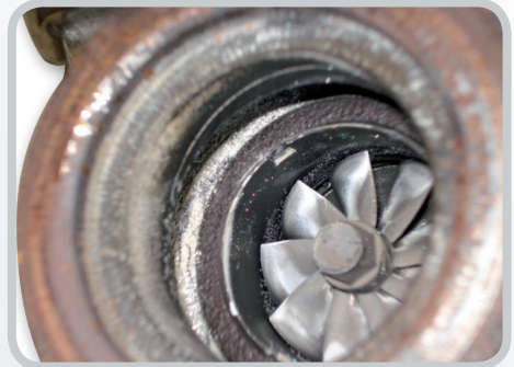
Bild Nr. 35: Kühlmittelspuren an der Turbinenseite des Krümmers
