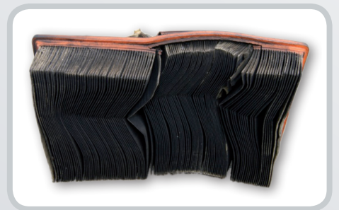
Bild Nr. 20: Verdreckter Luftfilter
