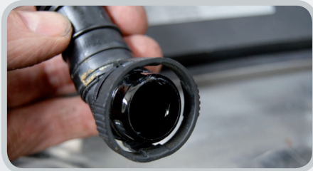
Bild Nr. 12: Deutlicher Ölstand in der Leitung der Motorenlüftung
