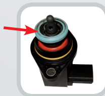
Bild Nr. 23: Angelöste Dichtung
