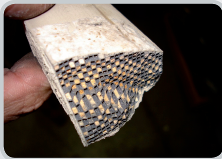
Bild Nr. 16: Verstopfter Partikelfilter
