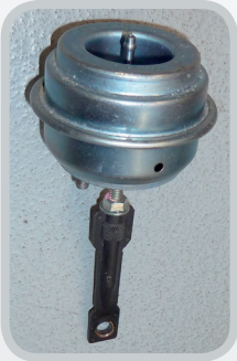
Pneumatisch gesteuerte Regeldosen, rechts mit Über-, Unter- und Steuerdruckanschlüssen
