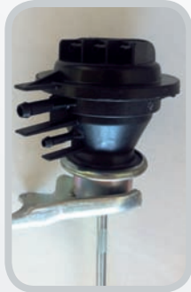
Pneumatisch gesteuerte Regeldosen, rechts mit Über-, Unter- und Steuerdruckanschlüssen
