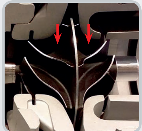
Rote Pfeile: zweiseitiges Verdichterrad
