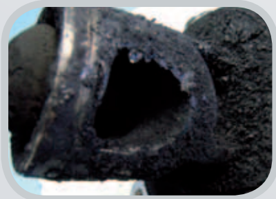
Starke Ablagerungen am AGR-Ventil und im Ansaugkrümmer führen zum Leistungsverlust und können einen defekten Turbolader „vorgaukeln“.
