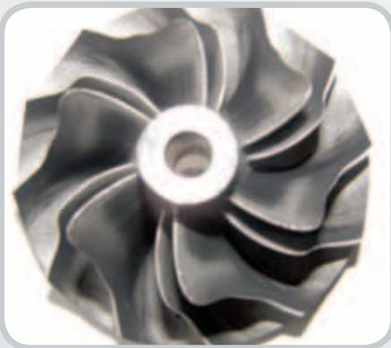
Verdichterradschaden durch Staub, Sand oder Schmutz
