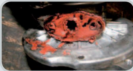
Die Verwendung von Dichtpaste am Ölrücklauf kann zu massivem Ölverlust führen, da nach innen gedrückte Dichtpaste den Querschnitt der Ölablaufbohrung verschließt.
