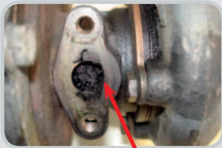
Starker Ölkohleaufbau im Lagergehäuse
