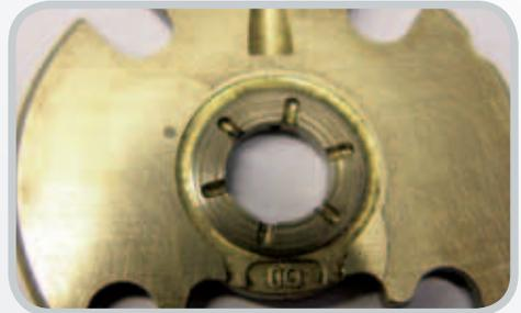
*Axiallagerverschleiß durch verschmutztes Öl*
