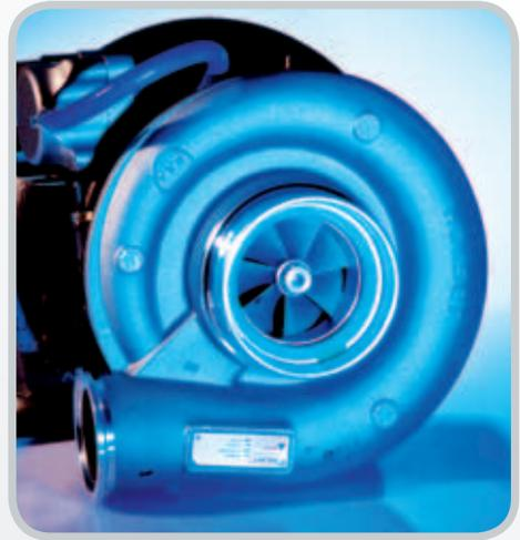
zeugbereich, dann aber auch bei den Pkw wurden Turbolader verstärkt eingesetzt. Ihren Teil trug in dieser Zeit auch die Formel 1 durch die Einführung des Abgasturboladers bei deren Boliden bei.
