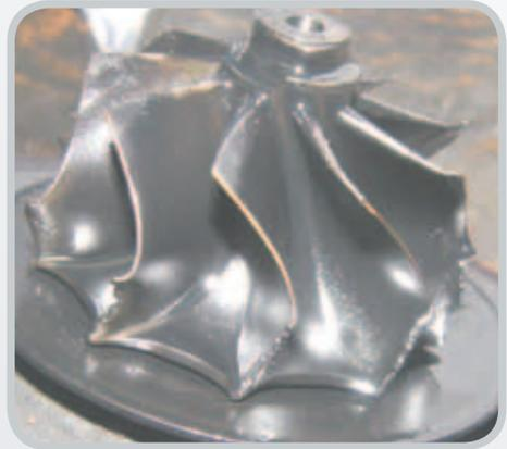
Fremdkörperschaden am Turbinenrad
