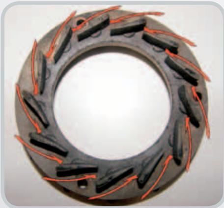
*Abgasstromverlauf am Leitring der VTG*
