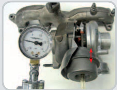
*Prüfung der VTG Verstellung*
