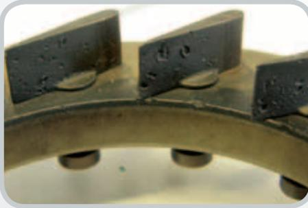
*Fremdkörperschaden an den Leitschaufeln der variablen Turbinengeometrie*
